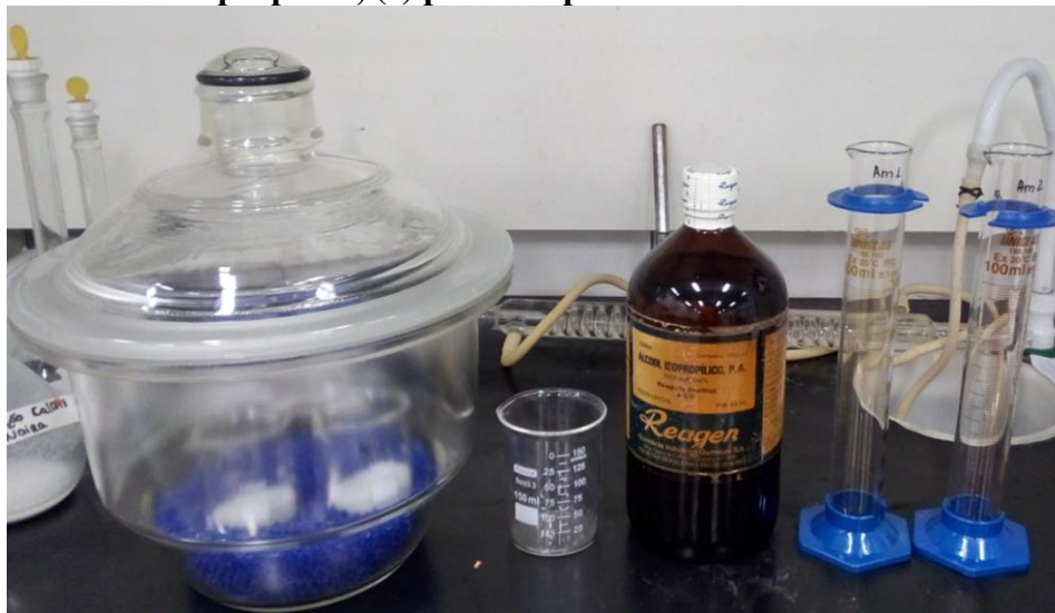
Figura 10: Sequência do experimento (a) resfriamento em dessecador; (b) medição do álcool isopropílico; (c) provetas para leitura do volume final.
