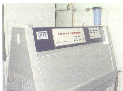
Figura 13 – Equipamento Q-Panel QUV
