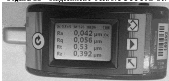
Figura 11 – Rugosímetro Tesa RUGOSURF 20.
