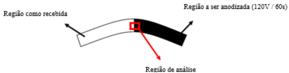
Figura 17 – Nióbio com região anodizada e região como recebida.
