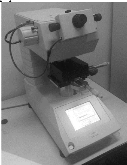
Figura 12 – Equipamento de microdureza Shimadzu HMV-2T E.
