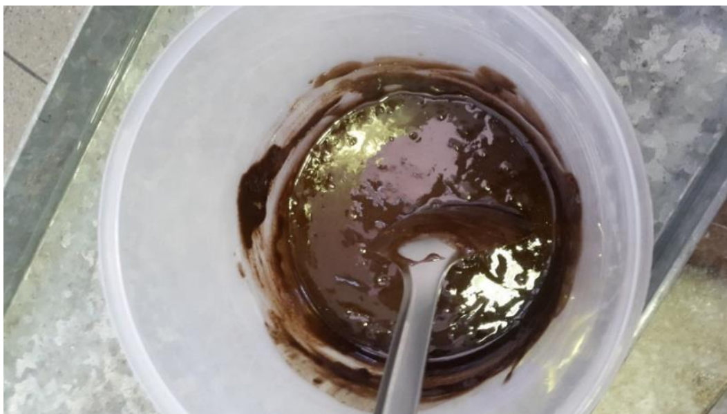
Figura 6 - Massa cerâmica obtida através da mistura do rejeito e da resina poliéster.
