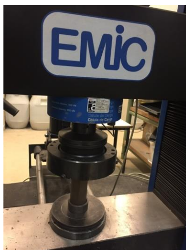
Figura 13 - Equipamento Universal de Ensaio.
