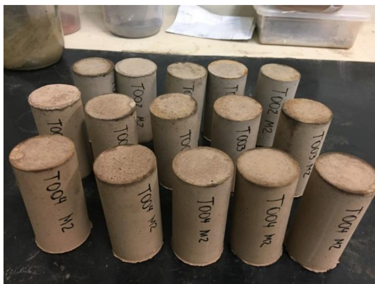
Figura 17 – Corpos de Prova moldados.
