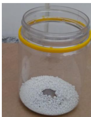
Figura 8 - Recipiente plástico contendo esferas de zircônia.
