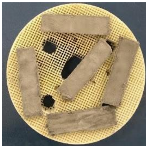
Figura 10 - Imagem representando corpos de prova a verde. No exemplo vê-se o grupo 5 (0,1%C).
