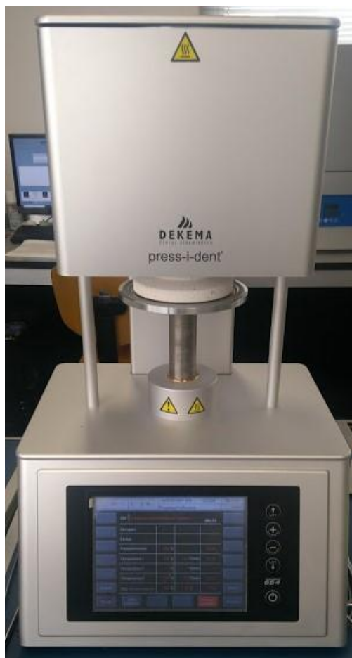
Figura 11 - Forno utilizado para a sinterização dos corpos de prova.
