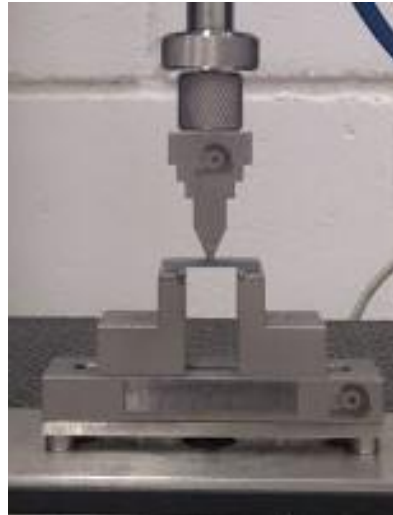
Figura 12 - Dispositivo utilizado para flexão em 3 pontos.
