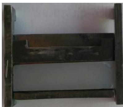
Figura 9 - Molde e modelo utilizados para a confecção dos corpos de prova.
