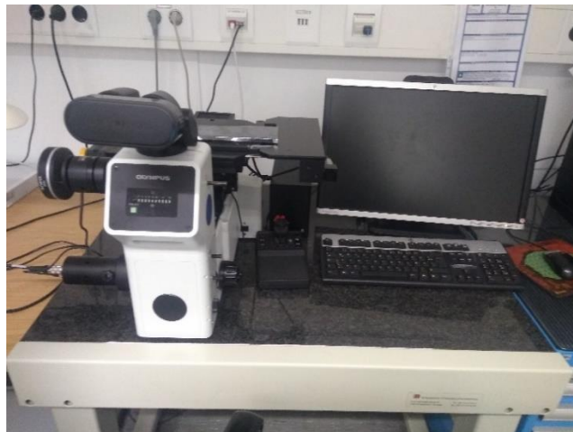
Figura 20 – Microscópio Ótico Olympus utilizado para análise microestrutural
