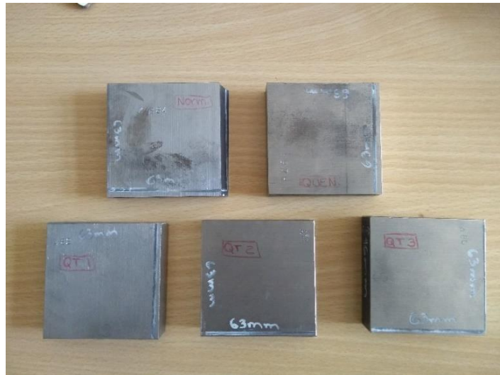
Figura 12 – Placas usinadas nas dimensões 63 mm x 63 mm x 16 mm
