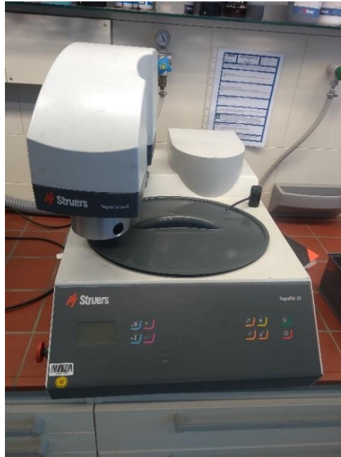
Figura 19 – Máquina Struers utilizada para lixamento e polimento das amostras
