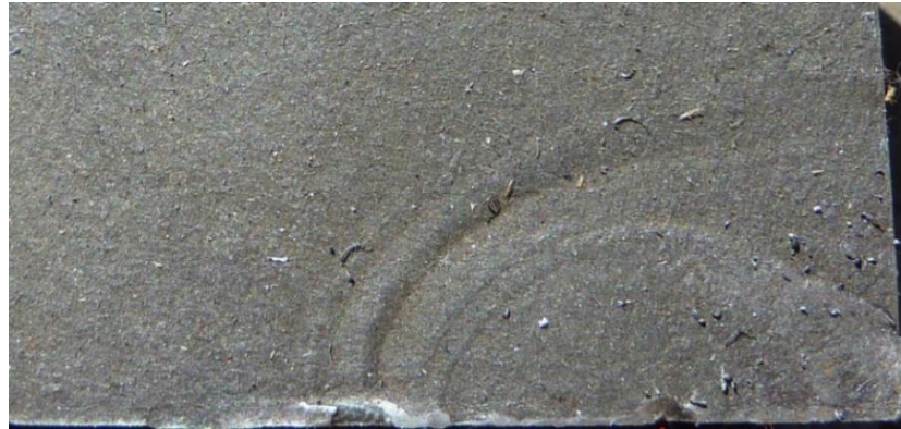
Figura 5 – Superfície fraturada por fadiga exibindo “beach marks”
