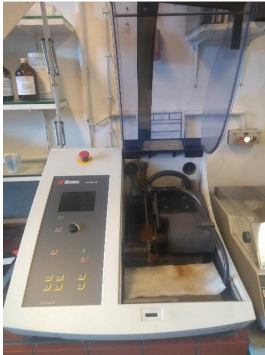
Figura 18 – Máquina Struers utilizada para corte das amostras
