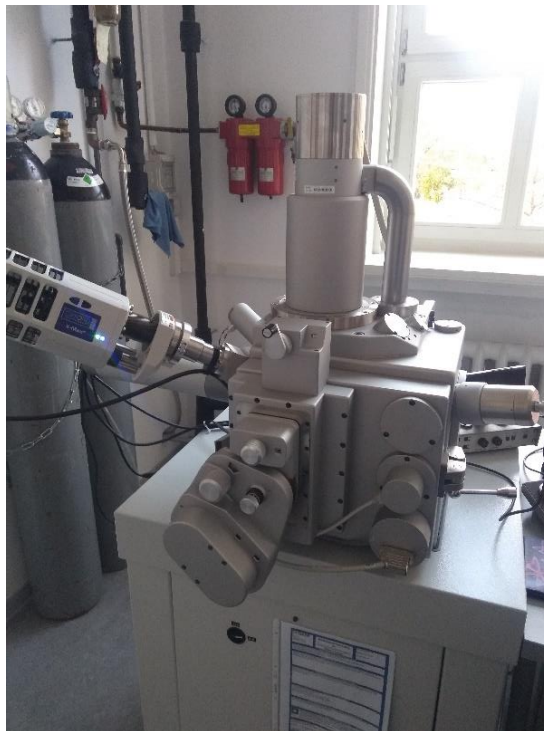
Figura 22 – Microscópio Eletrônico de Varredura Tescan utilizado para análise micrográfica
