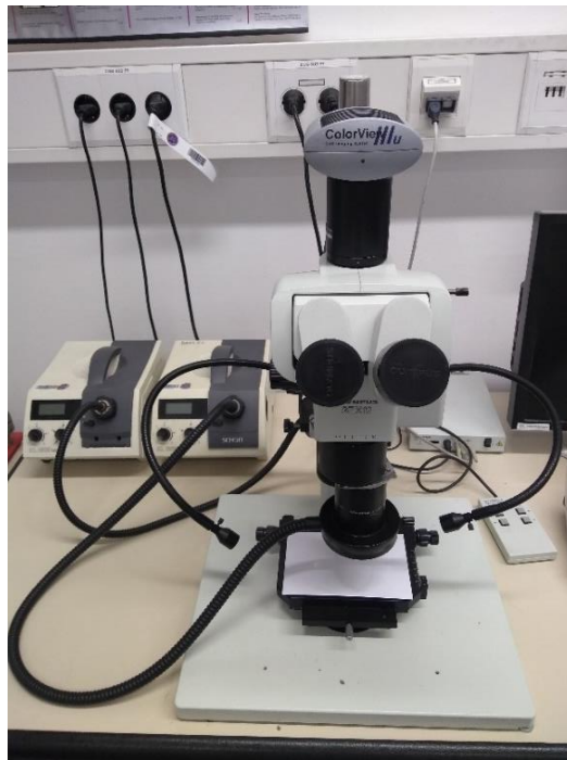
Figura 21 – Estereoscópio Olympus utilizado para análise macrográfica
