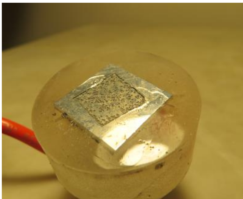
Figura 16: Corrosão da amostra polida
