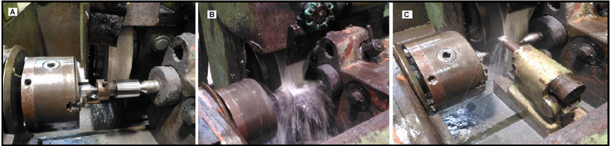
Figura 20: (a) operação de retificação (b) uso de fluido de retificação (c) operação de dressagem.
