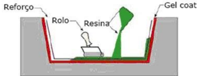
Figura 6 - Esquema de moldagem manual ( hand lay-up )
