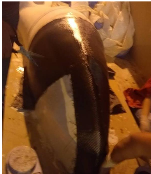
Figura 22 - Processamento por moldagem manual da carenagem
