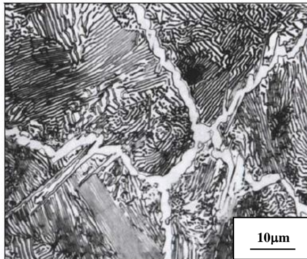
Figura 7 - Microscopia óptica apresentando uma rede de cementita pró-eutetóide ao longo de colônias de perlita, e as lamelas de cementita dentro das colônias de perlita.
