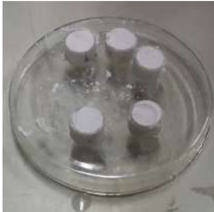
Figura 11 - Moldes dos corpos de prova preenchidos com pasta cimentícia
