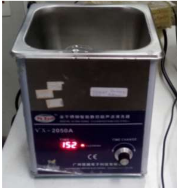
Figura 10 - Aparelho de ultrassom utilizado para dispersa o óxido de grafeno na solução
