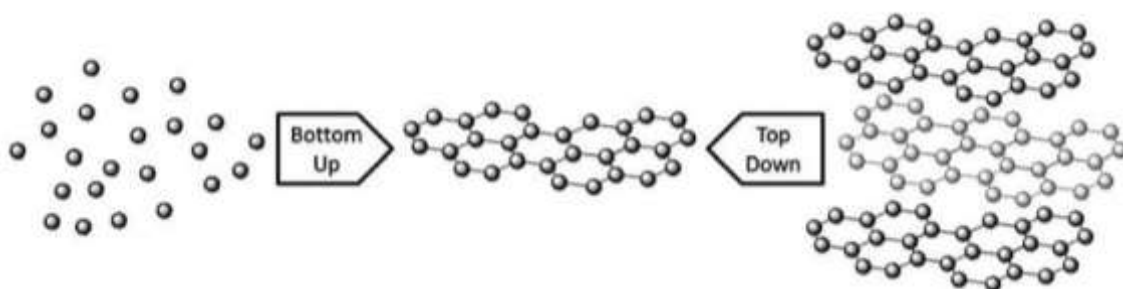
Figura 7 - Esquema de produção da abordagem top-down e bottom-up
