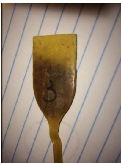
Figura 22: Parte superior amarela indica má fusão ou degradação.
