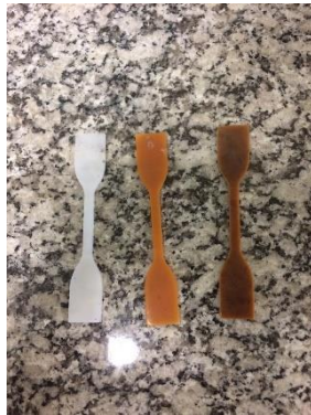
Figura 20: Corpos de prova ASTM D638, da esquerda para direita: Puro, 25g e 100g de urucum.
