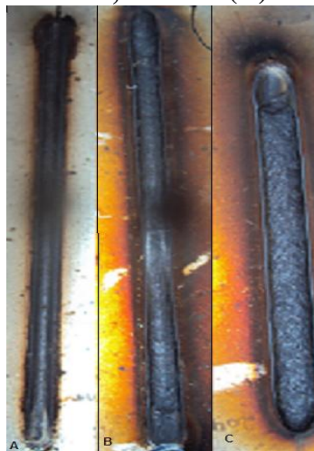
Figura 24 - Cordão de solda de acordo com o aporte térmico (A) cordão soldado com 0,5kJ/mm (B) cordão soldado com 1,0kJ/mm (C) cordão soldado com 1,5kJ/mm.
