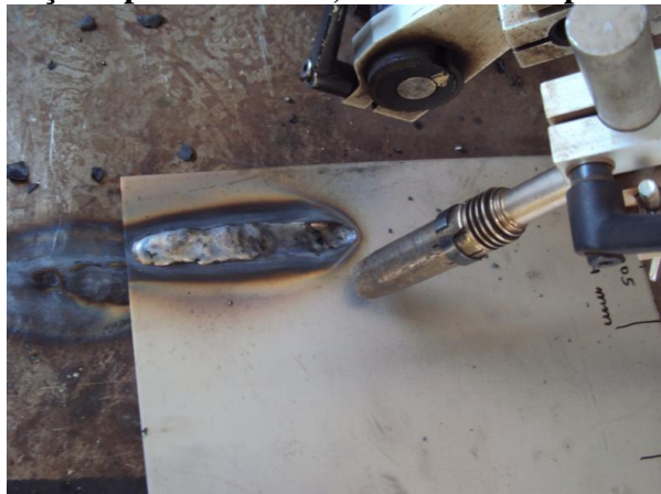
Figura 23 - Chapa de aço duplex SAF2205, soldada com aporte térmico de 2,5kJ/mm.
