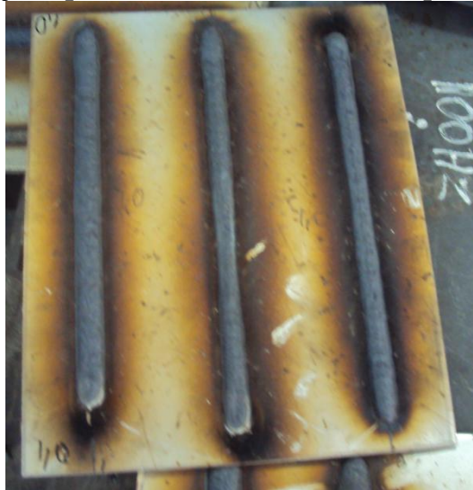
Figura 16 - Chapa de aço duplex SAF 2205 soldada com aporte térmico de 1,0 kJ/mm.
