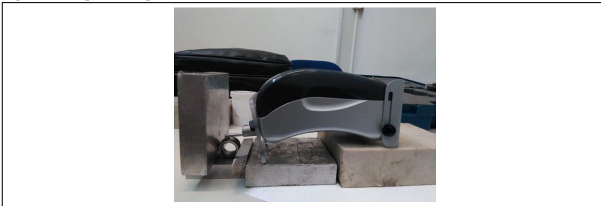
Figura 23 - Posicionamento do rugosímetro portátil e método de fixação durante medição da rugosidade da pista da capa interna.
