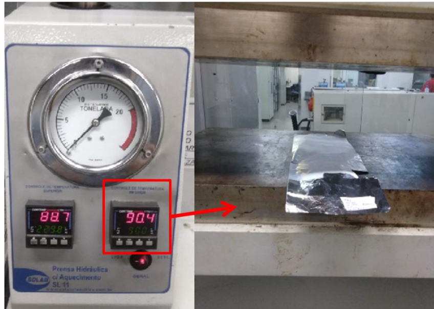
Figura 11 – Secagem das nanofibras na prensa
