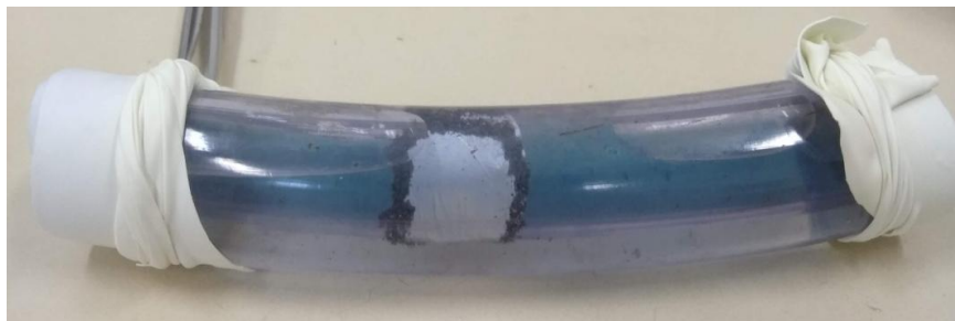
Figura 22 – Montagem do sistema de filtração por osmose
