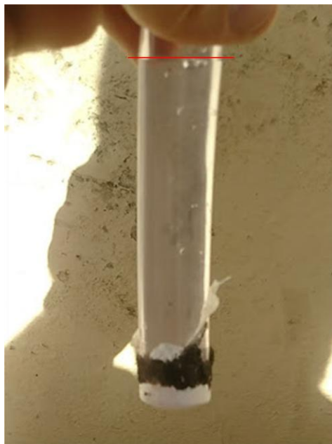
Figura 21 – Teste de filtração por gravidade por alta pressão
