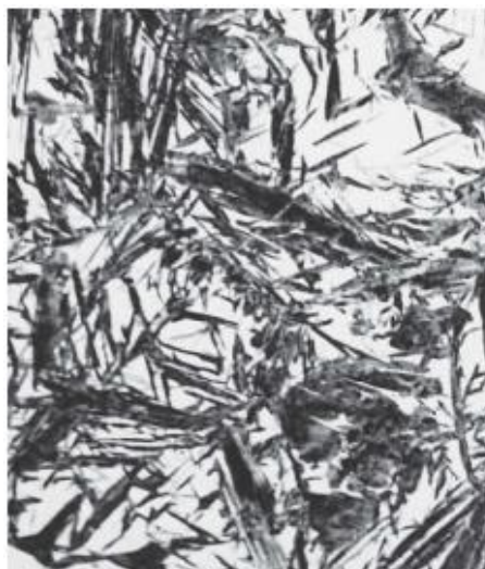
Figura 10 - Fotomicrografia apresentando a microestrutura martensítica lenticular ou em placas.
