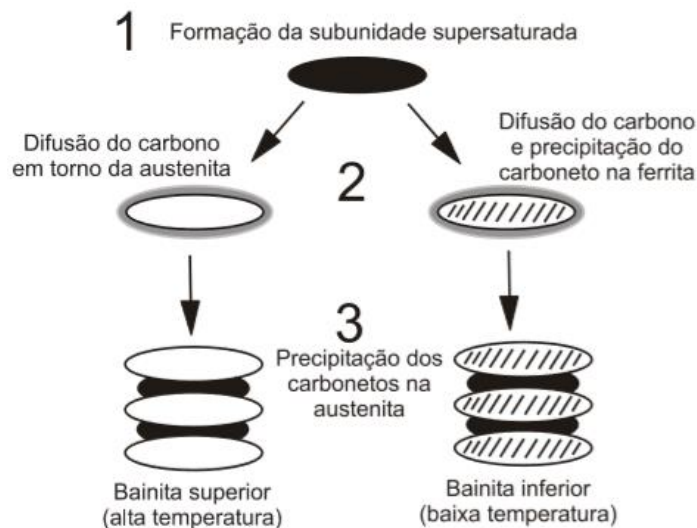
Figura 6 - Esquematização da formação da bainita superior e da bainita inferior.
