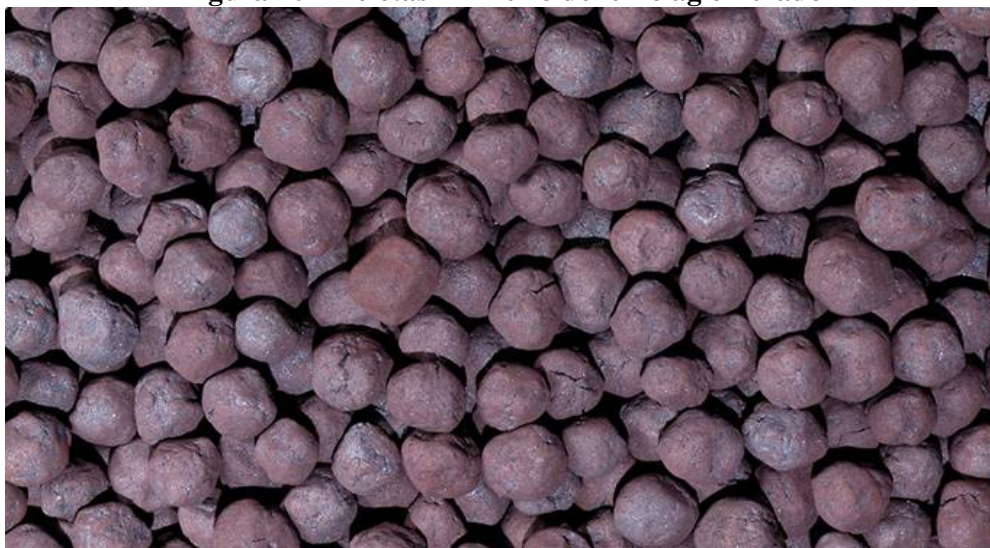
Figura 20 – Pelotas - minério de ferro aglomerado
