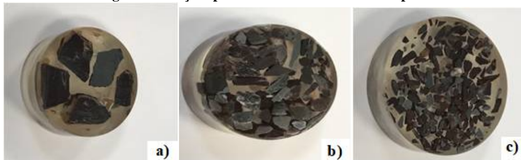
Figura 27- Seções polidas embutidas em resina epóxi.
