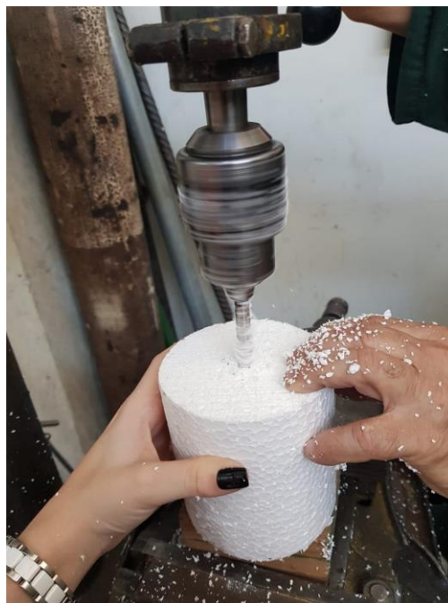
Figura 13 – Amostra de poliestireno expandido sendo furada.
