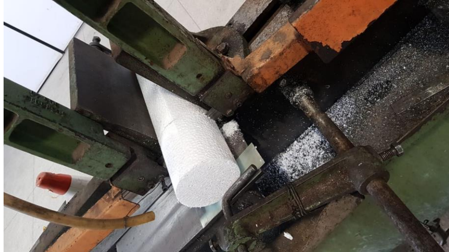
Figura 12 – Amostra de poliestireno expandido sendo cortado em quatro partes.
