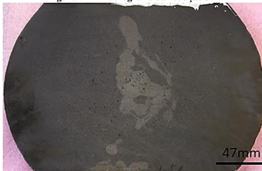
Figura 54 – Macrografia da redução 3:1.
