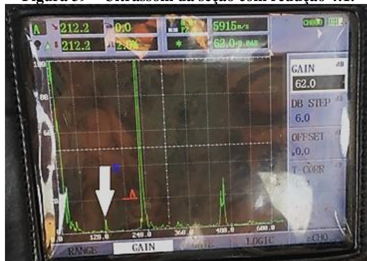
Figura 39 – Ultrassom da seção com redução 4:1.
