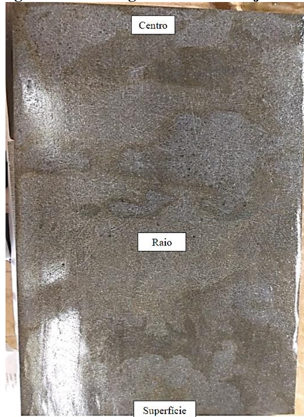
Figura 51 – Macrografia antes do forjamento.
