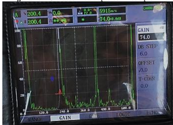
Figura 40 – Ultrassom da seção com redução 5:1.
