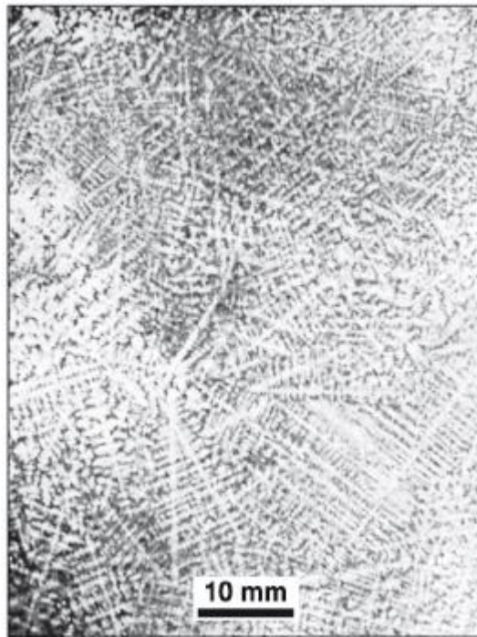
Figura 50 – Estrutura dendrítica em um aço.
