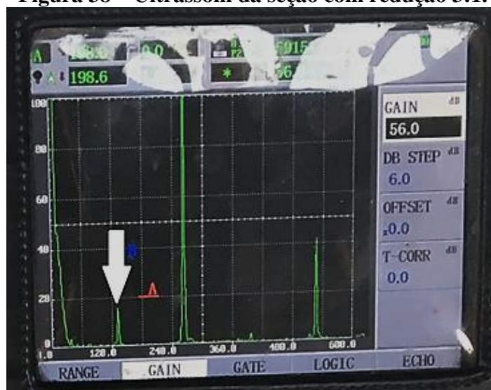
Figura 38 – Ultrassom da seção com redução 3:1.
