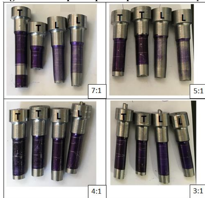
Figura 43 – Corpos de prova após ensaio de tração.
