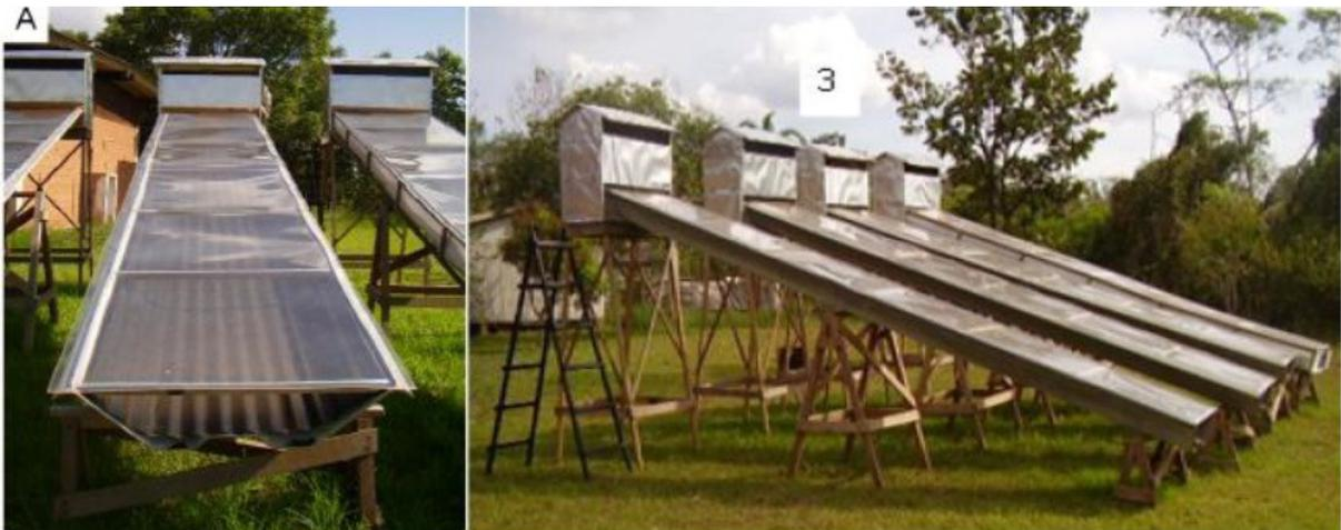
Legenda: Visão frontal (A) e lateral (3) do secador solar com telha de fibrocimento e telha de alumínio ondulada como superfície absorvedora.
