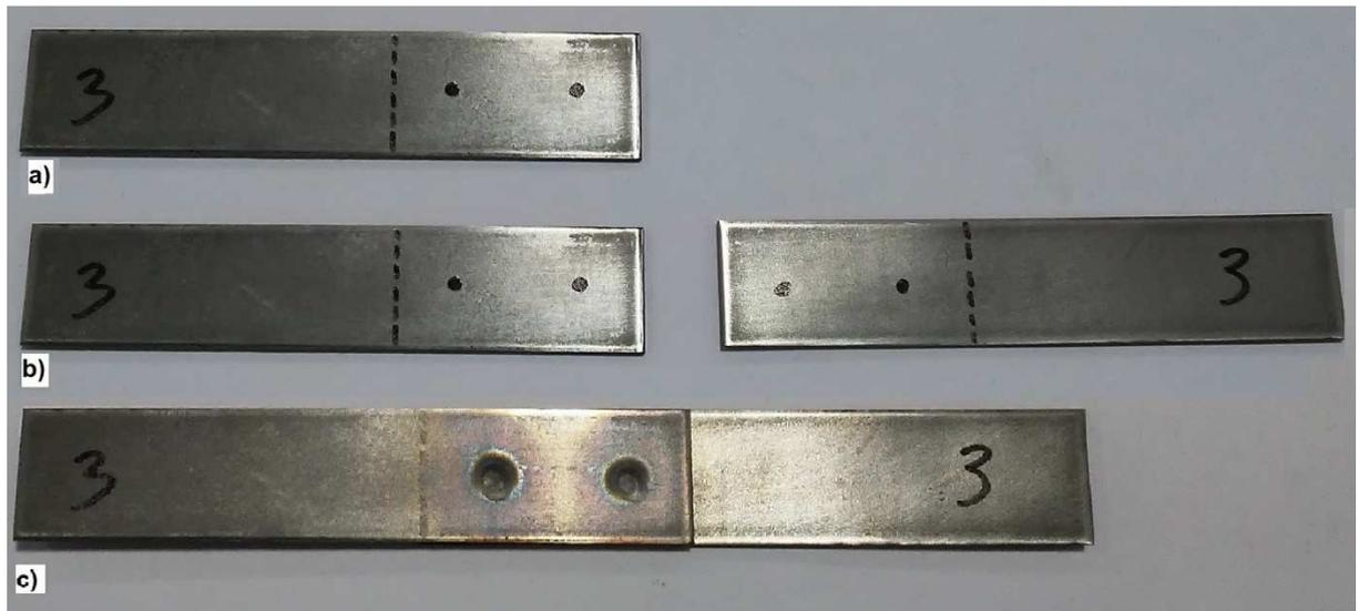
a) Peça demarcada b) Peças demarcadas com a indicação dos pontos de soldagem. c) Peças soldadas.
