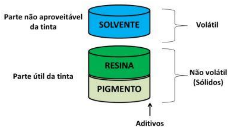
Figura 1- Composição básica das tintas
