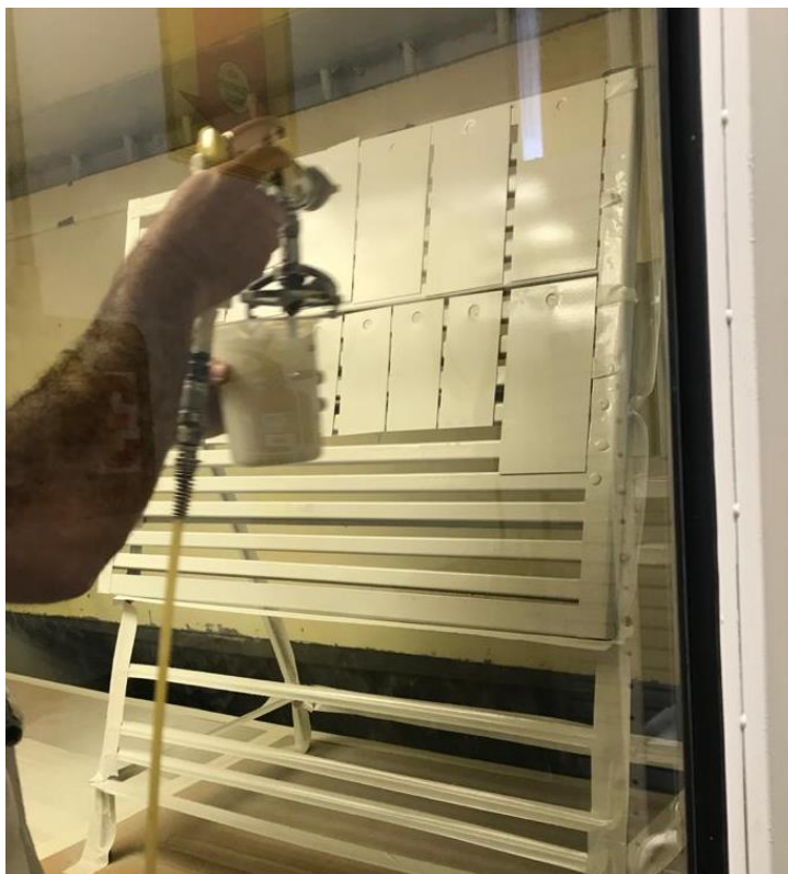
Figura 18 – Aplicação direta com uma pistola convencional em uma cabine de pintura
