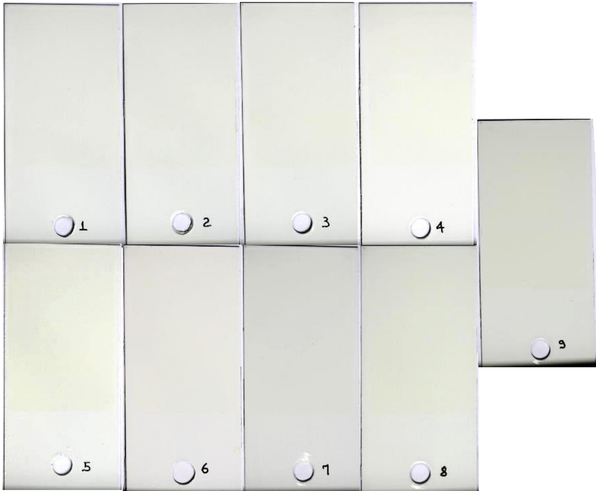
Figura 33 – Imagem dos corpos de prova após QUV 400 h
