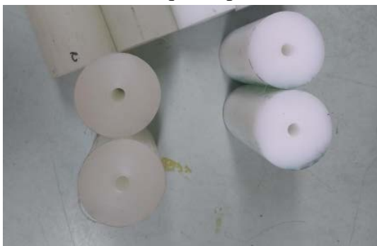
Figura 13 - Furo central nas quatro partes dos tubos poliméricos
