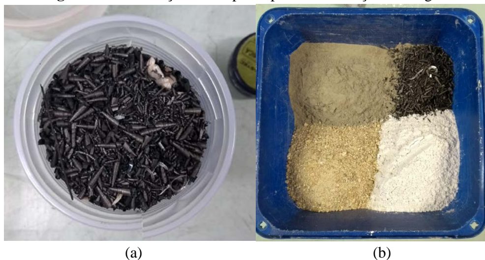
Figura 19 - Confecção do corpo de prova com adição de carga metálica
