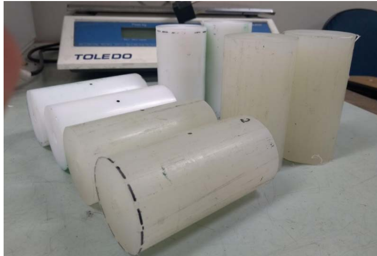
Figura 12 - Tubos poliméricos divididos em quatro partes
