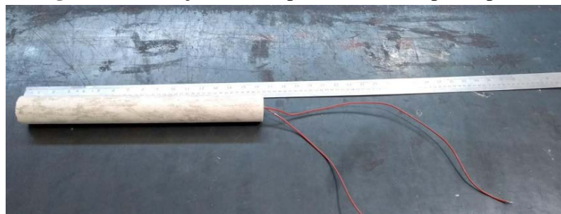
Figura 8 - Medição do comprimento do corpo de prova
