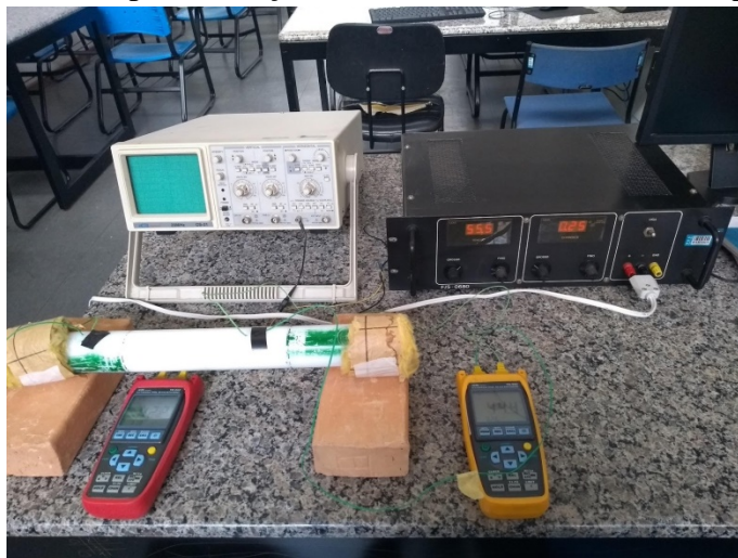
Figura 21 - Sistema para medição de condutividade térmica (k) para o PEAD
