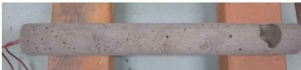
Figura 20 - Corpo de prova cerâmico com material metálico
