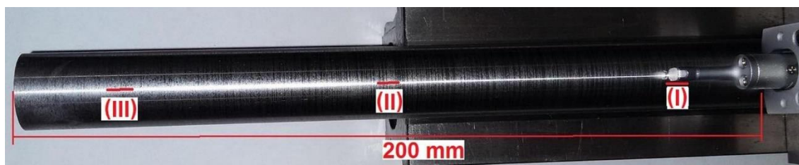
Figura 23 - Posição de leitura da rugosidade para as amostras
