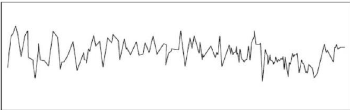
Figura 14 - Perfil efetivo, obtido com impressora de rugosímetro (filtrado)
