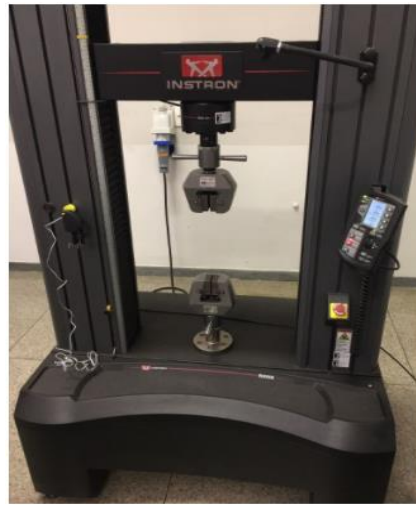
Figura 17 - Máquina universal de ensaios INSTRON 5982. (carga máx. 100 kN)
