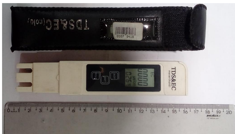
Figura 13 - Equipamento TDS&EC Meter usado para medição da condutividade do fluido antes e durante realização dos experimentos
