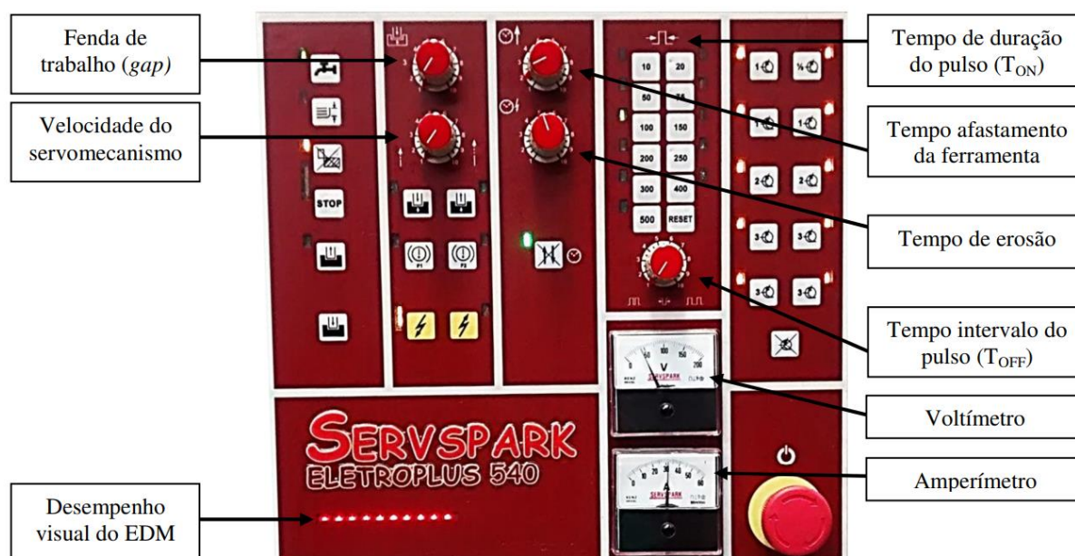
Figura 17 - Painel de controle da máquina EDM com indicação dos parâmetros ajustados
