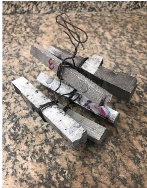
Figura 20- Gaiola de tratamento térmico
