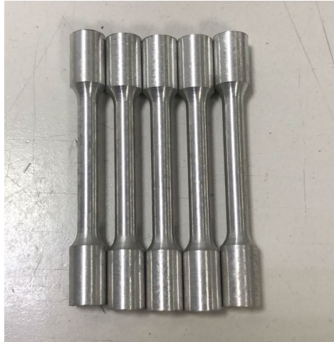
Figura 28 - Corpos de prova usinados ensaio de tração
