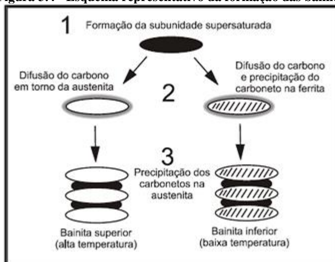
Figura 3.4 - Esquema representativo da formação das bainitas
