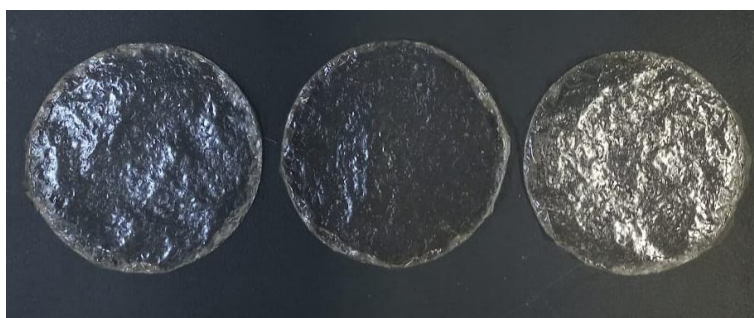
Figura 14 - Filmes de quitosana-alginato produzidos por evaporação em placa aberta à temperatura de 50 °C
