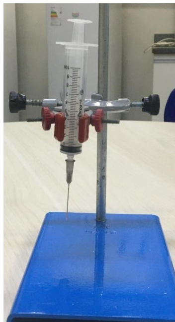
Figura 10 – Montagem utilizada para análise do tempo de pega dos corpos de prova
