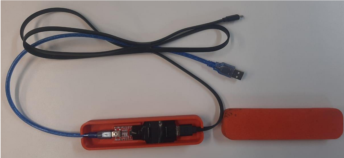
Figura 24- PCB envolto com suporte personalizado feito na impressora 3D.
