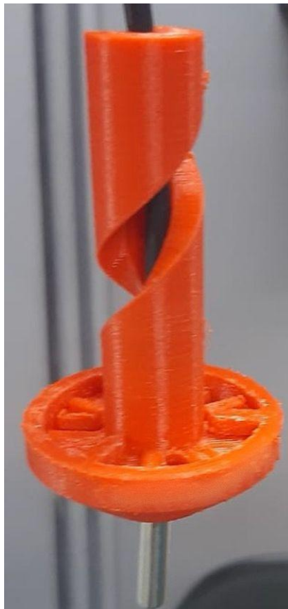
Figura 25 - Sensor de temperatura envolto com capa feita na impressora 3D.
