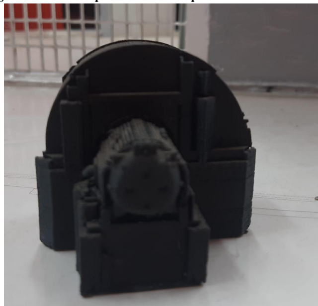
Figura 21 - Blower produzido via impressão 3D em escala 1:25.
