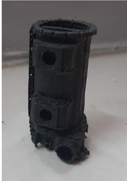
Figura 22 - Resfriador de Óleo produzido via impressão 3D em escala 1:25.
