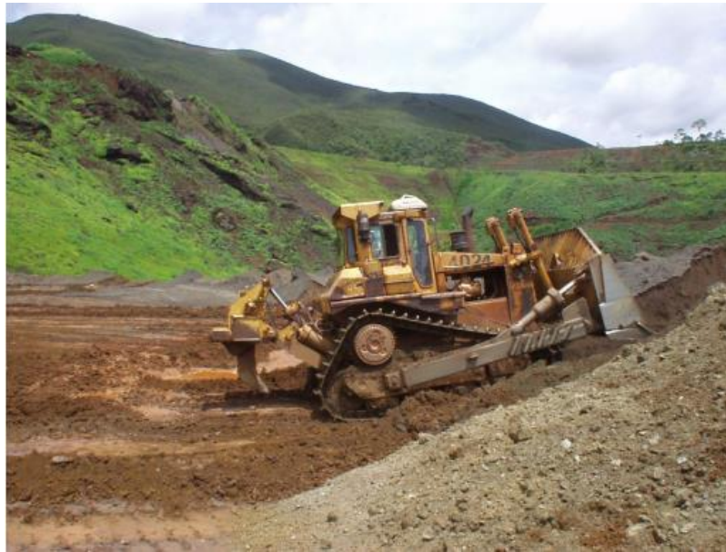
Figura 1 - Trator atuando no nivelamento da pilha de estéril da mina de Timbopeba da Vale
