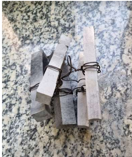
Figura 16 – Corpos de prova organizados em “gaiolas” de arame
