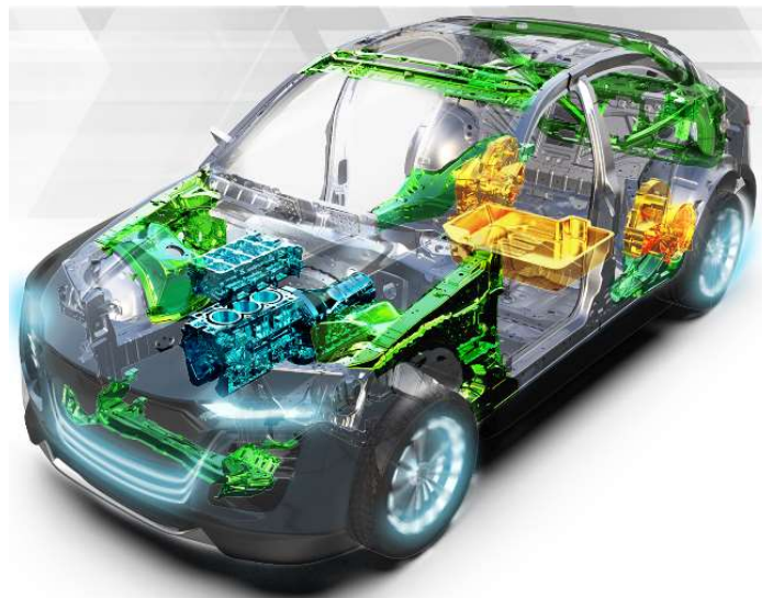
Figura 3 – Desenho esquemático de um automóvel com componentes feitos de alumínio em sua construção
