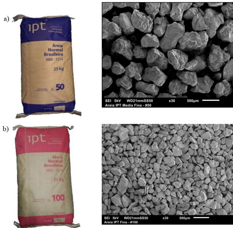
Figura 10 - a) Embalagem de Areia Normal Brasileira #50 e imagem dos grãos abrasivos no MEV com aumento de 30x; b) Embalagem de Areia Normal Brasileira #100 e imagem dos grãos abrasivos no MEV com aumento de 30x.
