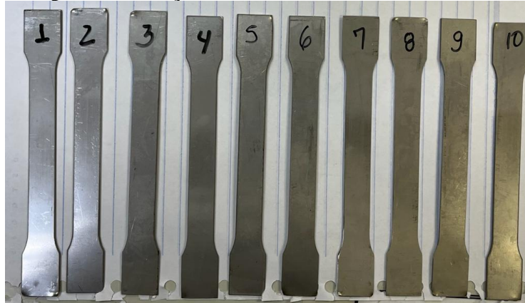
Figura 27: Corpos de prova de tração antes do ensaio de imersão em solução sanitizante.
