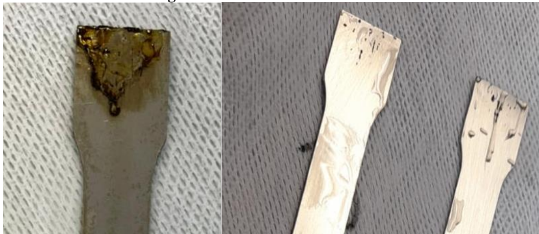
Figura 29: Corrosão nas amostras
