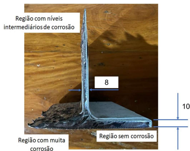
Figura 5.2 – Condição visual de uma das amostras retirada da viga do espessador (medidas em mm)
