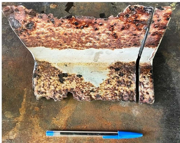
Figura 4.5 – Corte feito na amostra para os ensaios de microdureza e microscopia
