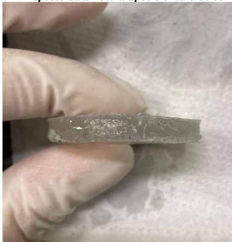
Figura 14 - Aspecto da amostra após o ensaio de compressão.
