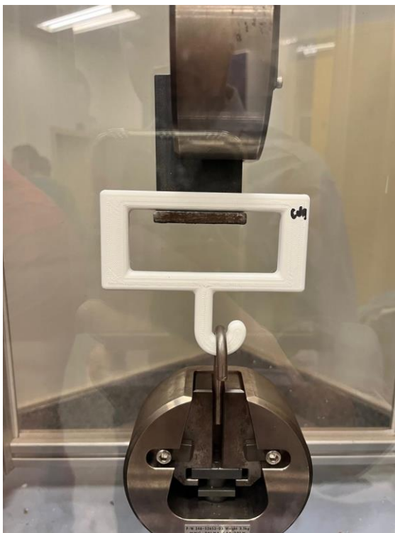
Figura 29 – Ensaio de tração do dispositivo de carga para sacolas plásticas
