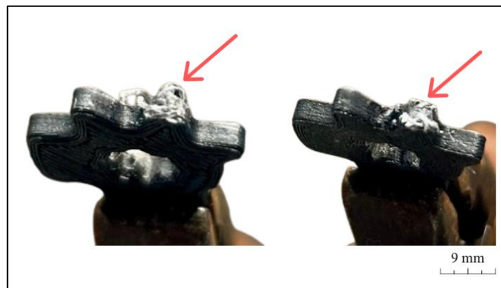
Figura 5.12 – Pontos de desgaste na área superficial das amostras C50 após ensaio cíclico
