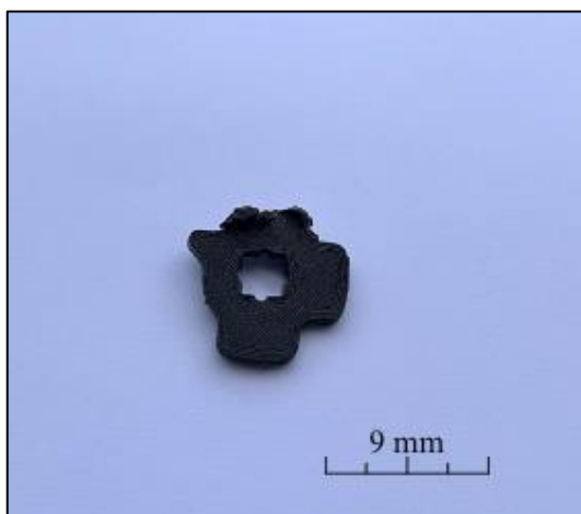
Figura 5.8 – Cames impresso com 100% de preenchimento após ensaio cíclico
