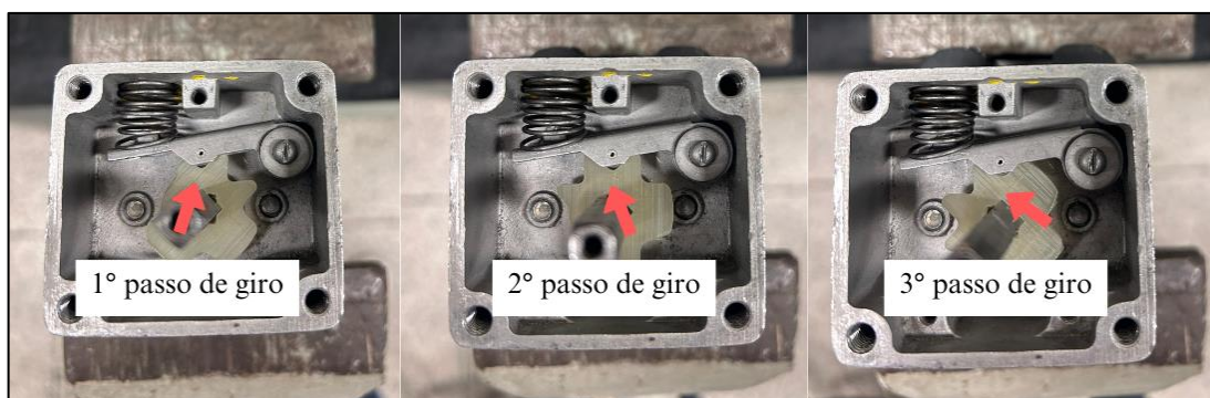
Figura 4.6 – Movimento angular do cames na chave elétrica
